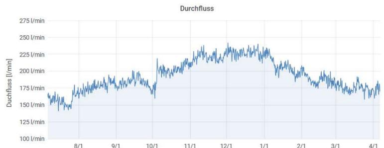
Ein Überlauf von ca. 200l/min ist relativ viel. Aus diesem Grund kam die Idee, das Wasser mit einer Wasserturbine zu nutzen und Strom zu erzeugen, da der Wasserbau resp. die Leitung zu Mittelstation schon besteht. Die Turbine könnte in der Mittelstation installiert werden und die beiden Bahnmotoren unterstützen.
